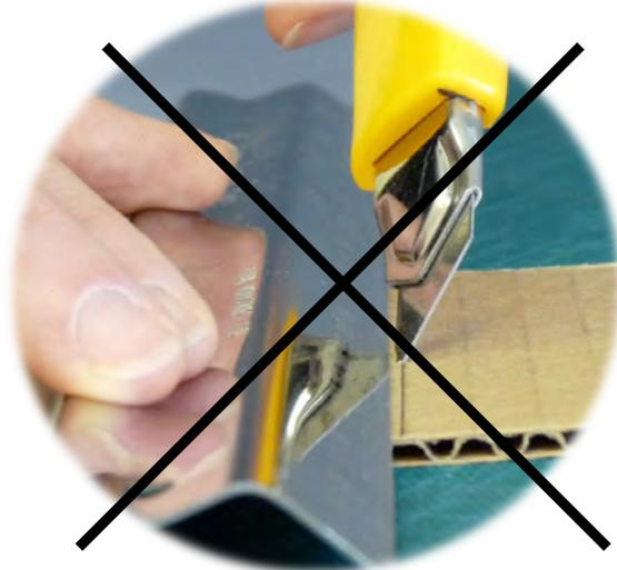
La lame ne doit pas être trop sortie lors de la coupe.
