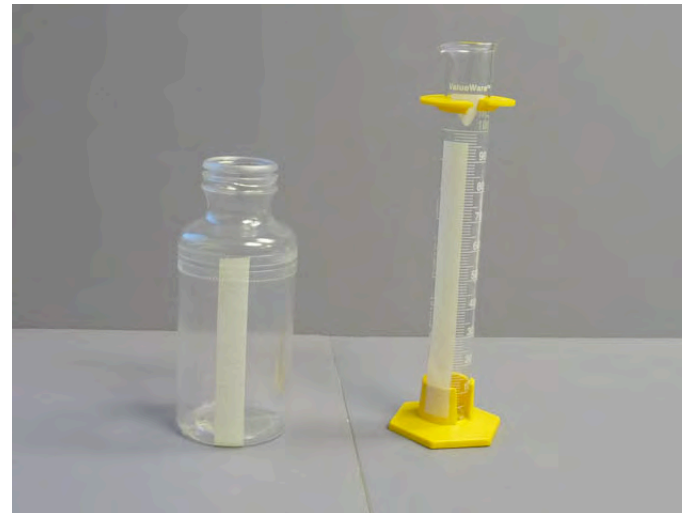
Bouteille et cylindre gradué avec ruban à masquer pour marquer les niveaux d'eau de chacun des verres.
