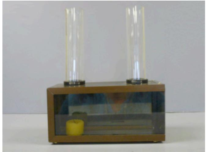
La bougie réchauffe l'air de la boîte. Cet air réchauffé devient plus léger et monte dans la cheminée. Cela crée un courant qui entraîne la fumée produite par le papier à l'intérieur de la boîte.
