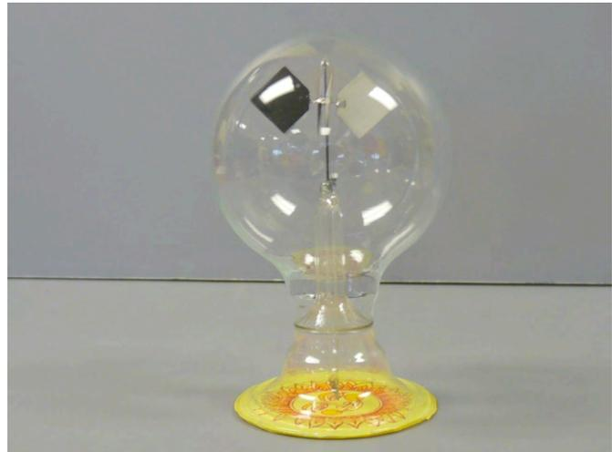
La surface noire absorbe le rayonnement et s'échauffe plus que la surface blanche. Les molécules de gaz à l'intérieur du radiomètre s'échauffent du côté noir et acquièrent une vitesse plus élevée. Cela donne une pression cinétique sur les plaques noires et cela fait tourner les plaques du noir vers le blanc.
