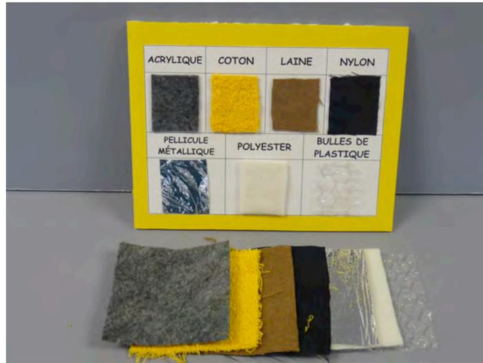
Il est essentiel d'avoir un système pour identifier les tissus. Voici un exemple de panneau permettant d'identifier les sortes de tissus utilisés lors de l'expérimentation. Il suffit de coller les échantillons dans la case correspondante.
