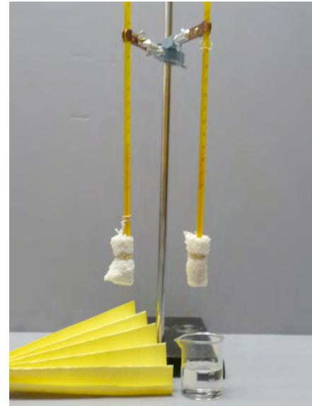
On peut remplacer tout le matériel de cette démonstration par un instrument de mesure appelé : Psychromètre
