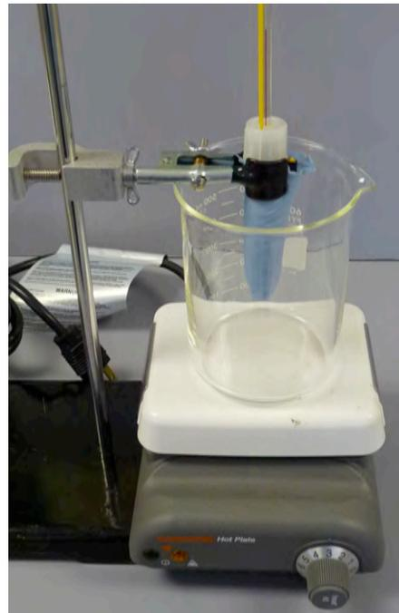
**À noter :** Sur les deux photos, il devrait y avoir un thermomètre et une pince à thermomètre afin de vérifier la température du becher dans lequel les tests sont effectués. Il est important de conserver la même température pour l'ensemble des élèves.
