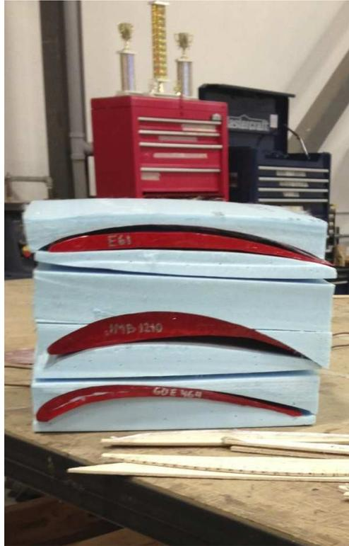
Figure J.9 : Profils d'aile finaux, entourés par la styromousse dans lequel ils ont été coupés
