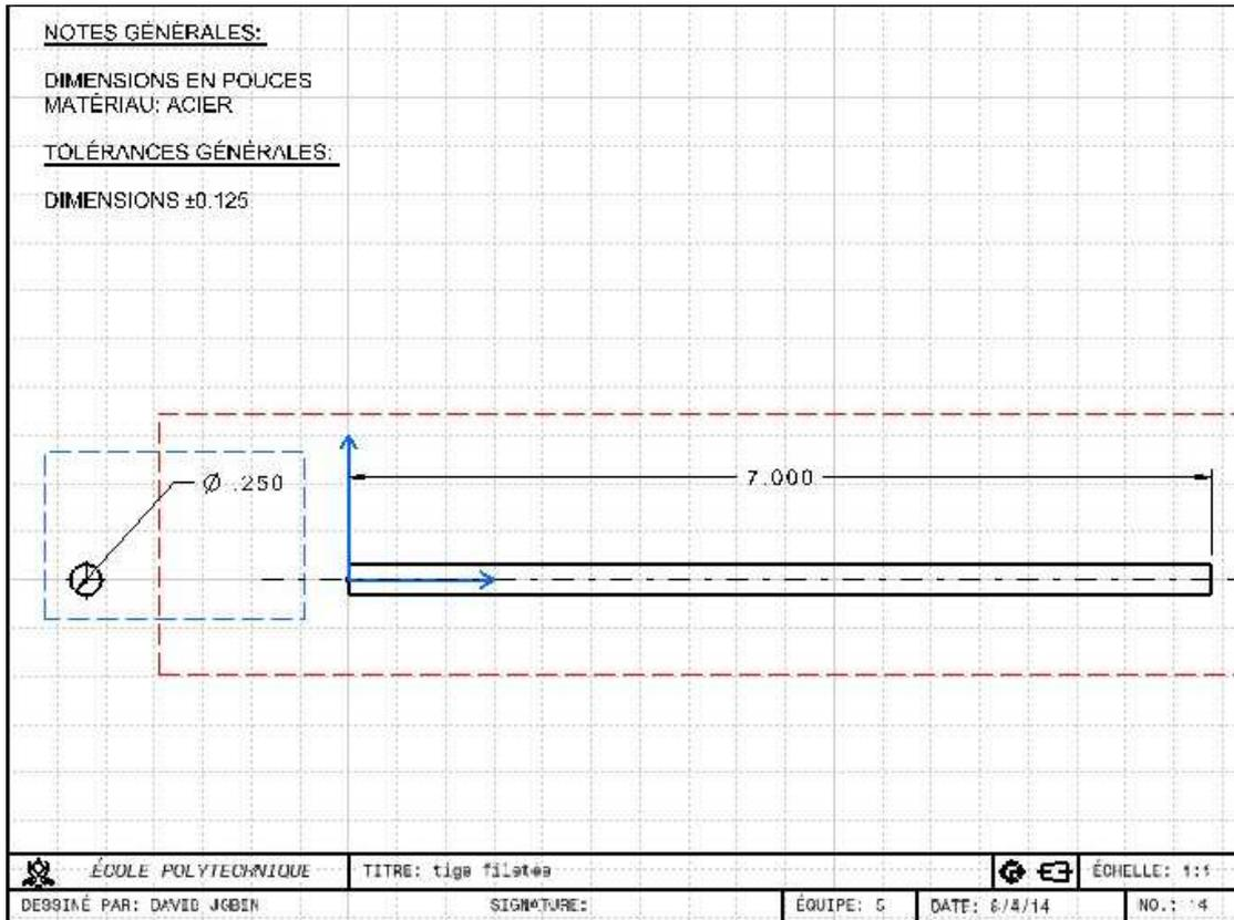
Figure H.15 : Dessin technique de la tige filetée (pièces tige x2)
