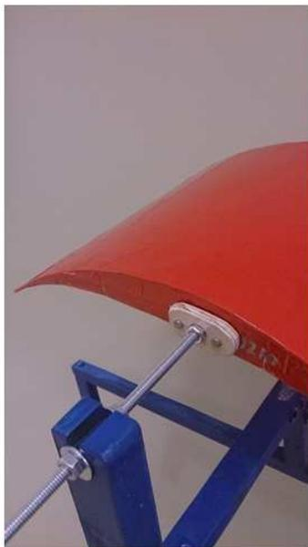
Figure J.8 : Systèmes d'attache pour les ailes
