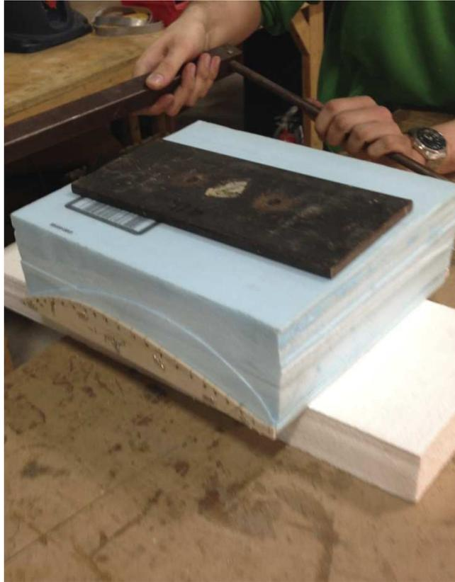
Figure J.12 : *Coupage des profils d'aile dans de la styromousse à l'aide d'un fil chauffant*
