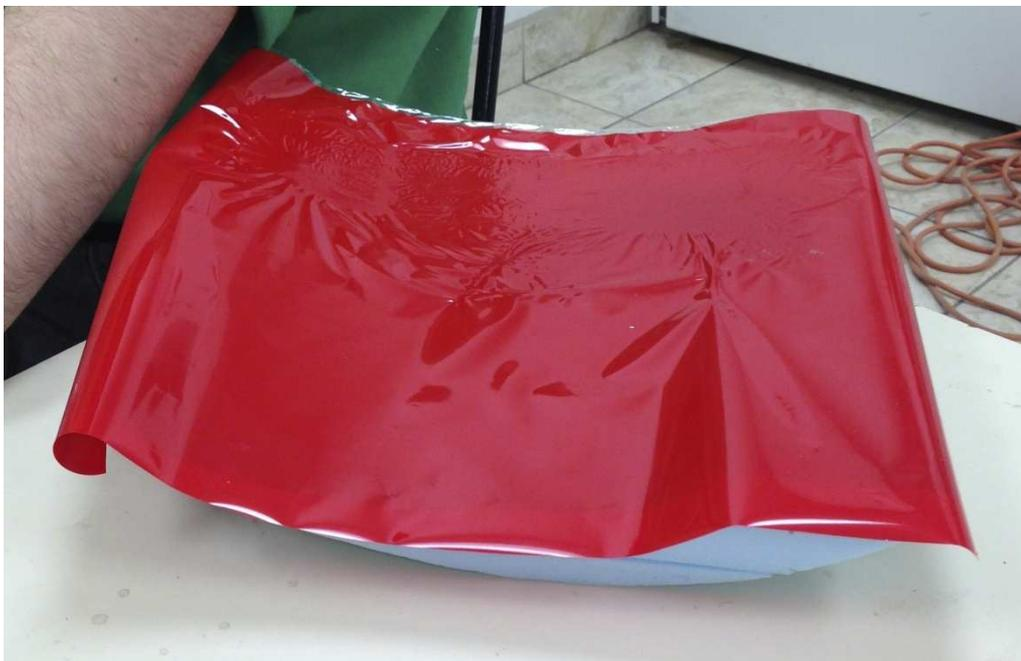
Figure J.13 : *Recouvrement des profils d'aile dans du plastique de type MonoKote*
