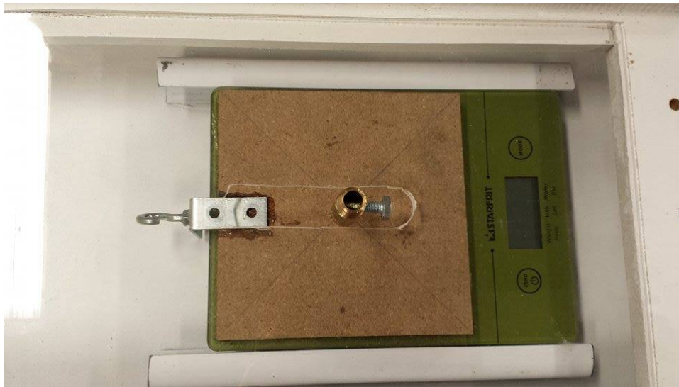
Figure 20: Système de mesure de portance (photo)
