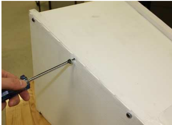
Figure 4.4. Boulonnage des longerons GFA-02-03 Figure 4.3. Sous-assemblage GFA-02 final
