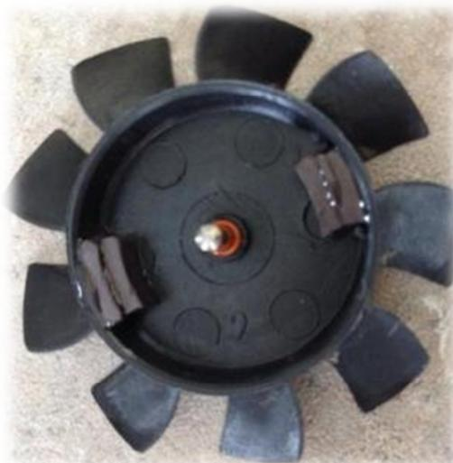
Sur la plaquette de l'axe, il faut coller le transistor à effet Hall de manière à ce qu'il fasse face aux aimants lors de la rotation. La figure 6.4 ci-dessous représente le résultat de ce collage.
