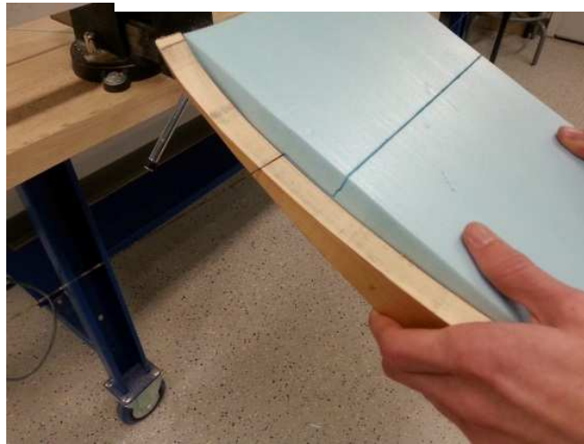
Fig.24 – Profil d'aile durant le découpage par fil chaud
