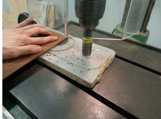
Fig.6 – Support de plexiglas durant l'étape de perçage
